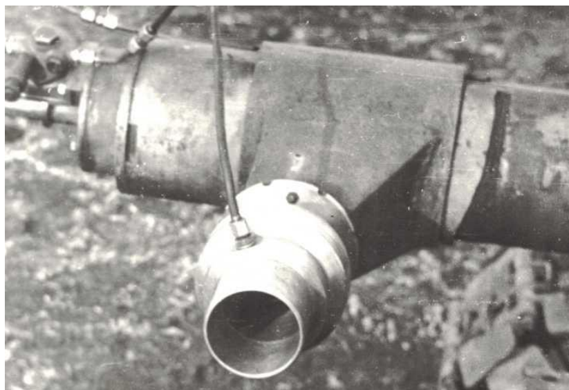
Рисунок 1.6 - Фото мунштука с устройством для внесения раствора модификатора на поверхность торфяного куска при вязкопластичной экструзии
