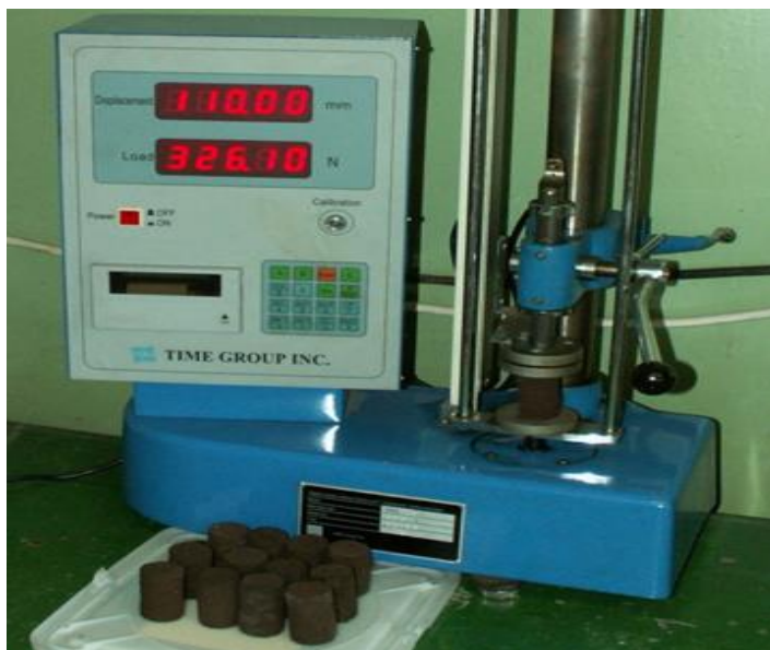
Рисунок 2.3 - Экспериментальная установка для испытания цилиндрических кусков на сжатие
