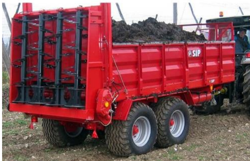
Рисунок 4.7 - Машина для внесения органических удобрений на поверхность поля
