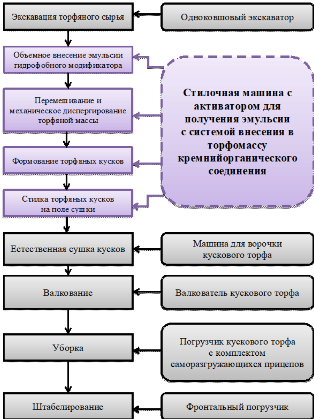
Рисунок 4.1 - Структурная схема технологии добычи (производства) кускового торфа
