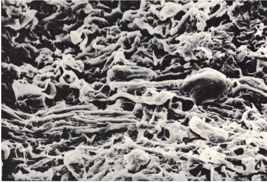
Рисунок 3.25 - Фрагмент структуры торфяного куска, полученного из переходного торфа высокой степени разложения (500-кратное увеличение)
