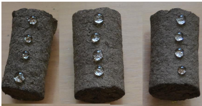
Рисунок 2.7 - Эксперимент по определению водоотталкивающих свойств торфа
