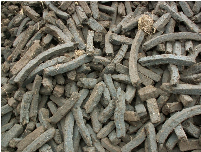
Рисунок 1.1 - Фото производимого в полевых условиях кускового торфа
