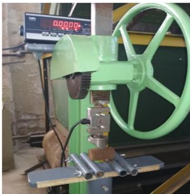
Рисунок 2.6 - Определение прочности образцов кускового торфа цилиндрической формы на изгиб
