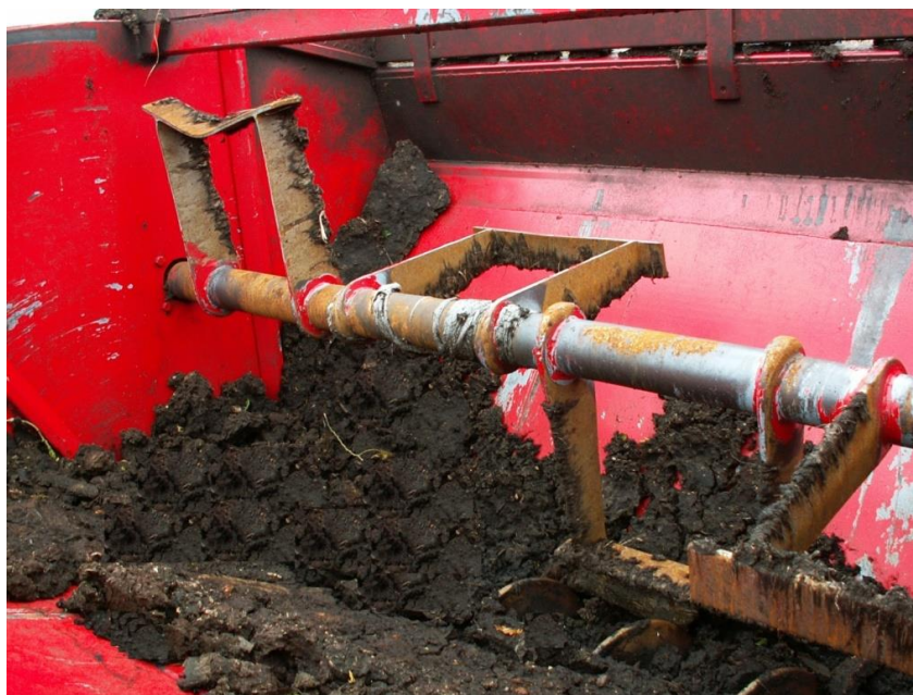
Рисунок 1.7 - Фото перемешивающего устройства для распределения раствора модификатора в объеме торфомассы перед вязкопластичной экструзией
