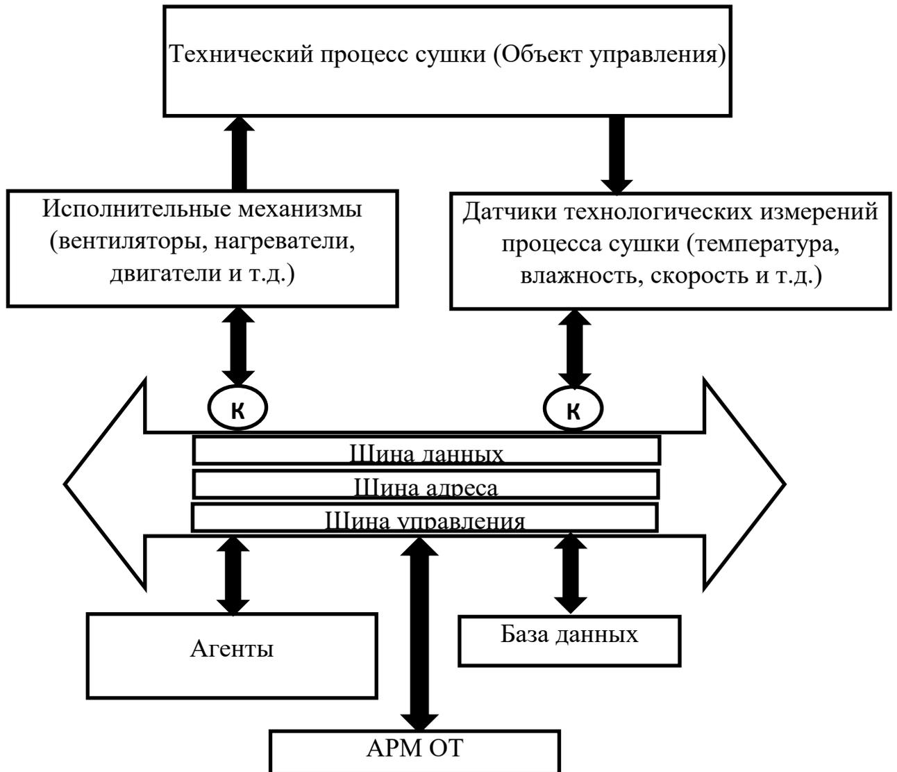
Рисунок 4.3 – Структура обмена информации АСУ ТП сушки
