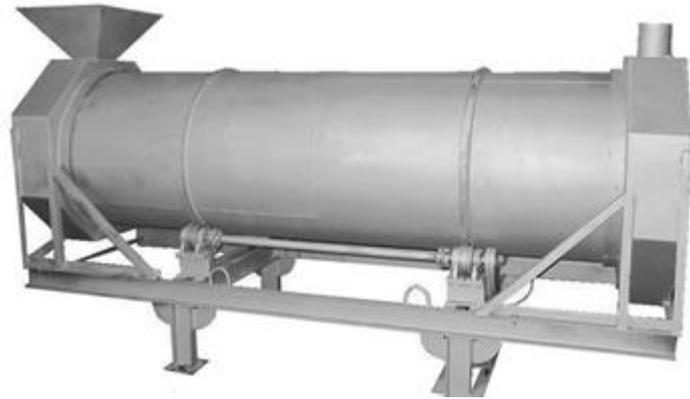
Рисунок 1.2 – Пример внешнего вида барабанной сушилки
