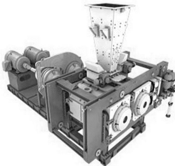
Рисунок 1.7 – Общий вид валково-мельничной дробилки высокого давления
