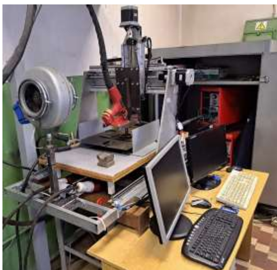
Рис. 3.2. Установка для послойного электродугового наплавления
