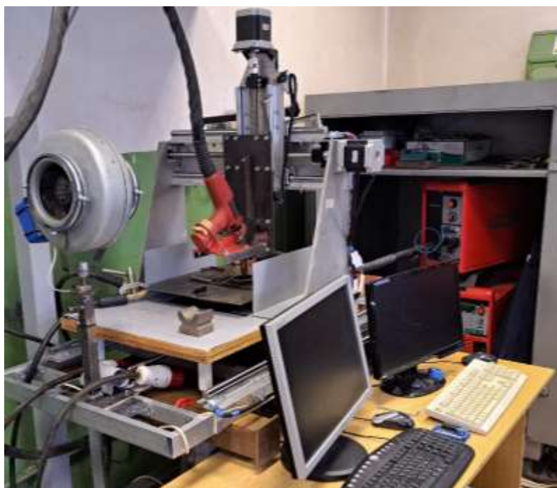
Рис. 1.9. Установка для 3D печати металлических деталей
