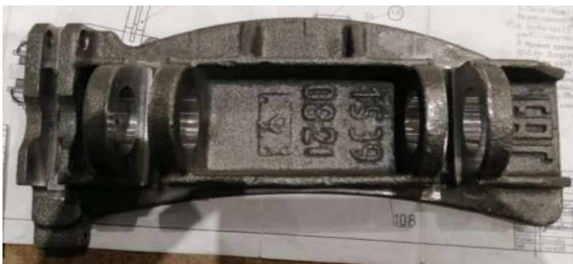
Рис. 4.7. Литой башмак дискового тормоза
