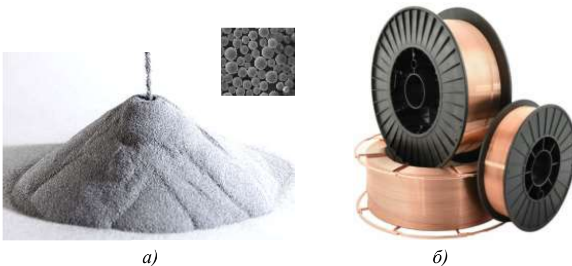
Рис. 1.1. Типы присадочного материала: а) порошковый материал; б) проволочный материал
