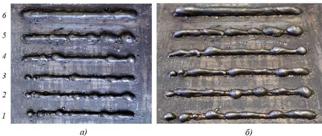
Рис. 3.5. Результаты эксперимента по отработке режимов наплавления:
