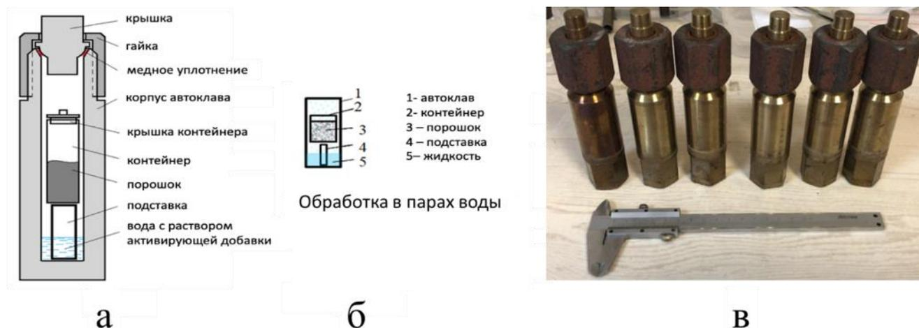
Рисунок 25 – Схема и фотография лабораторных автоклавов: а – схема лабораторного автоклава; б – схема обработки в парах воды; в – фотография автоклавов
