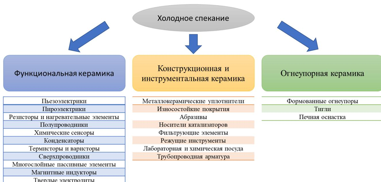
Рисунок 3 – Потенциальные приложения процесса ХС для изготовления керамики различного назначения [20], [29]
