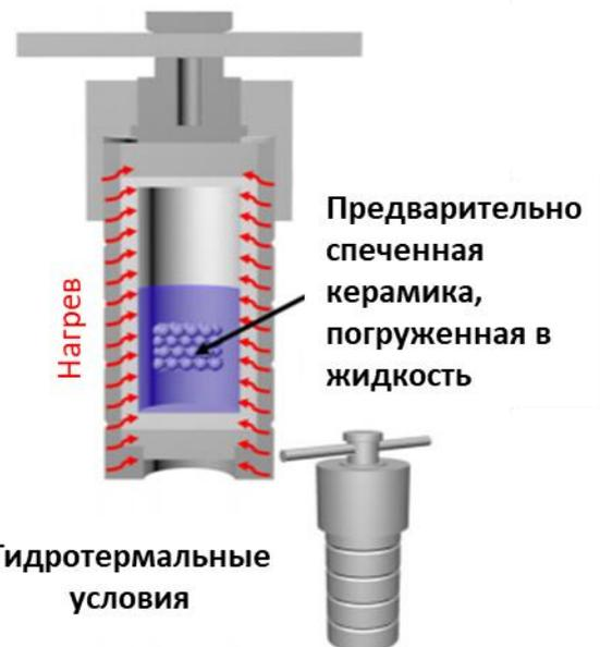
Рисунок 1 – Установки для спекания при пониженных температурах [2]:
