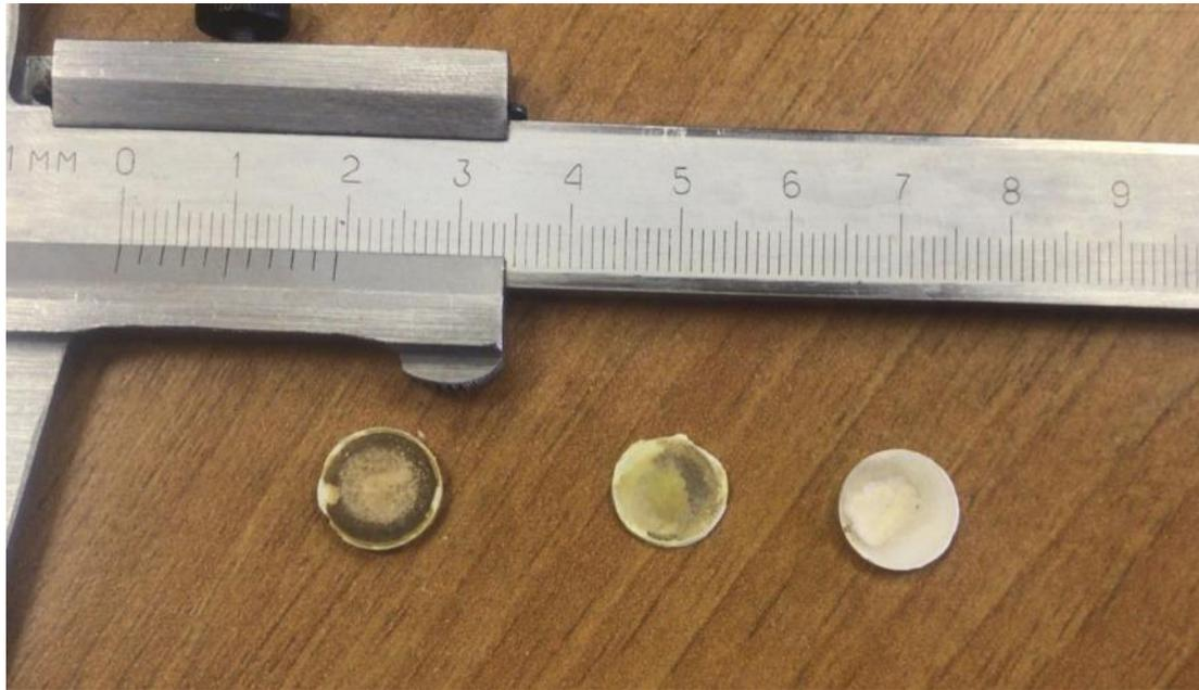
Рисунок 67 – Образцы керамики из ZnO, изготовленные методом ХС
