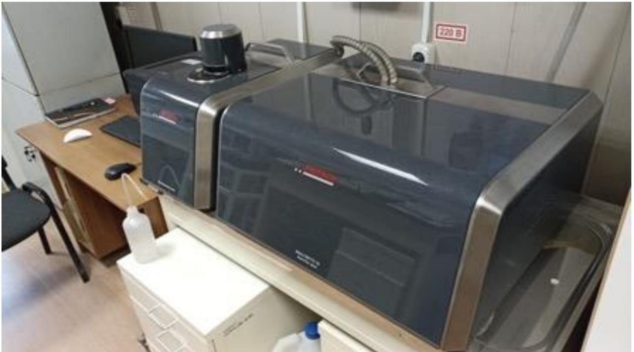
Рисунок 32 – Лазерный анализатор частиц FRITSCH ANALYZETTE 22 NANOTEC PLUS
