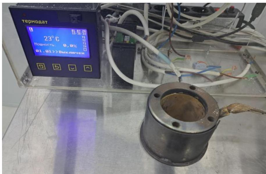
Рисунок 28 – Кольцевой латунный электронагреватель ЭНКМЛ и ПИД-контроллер температуры Термодат-17Е6
