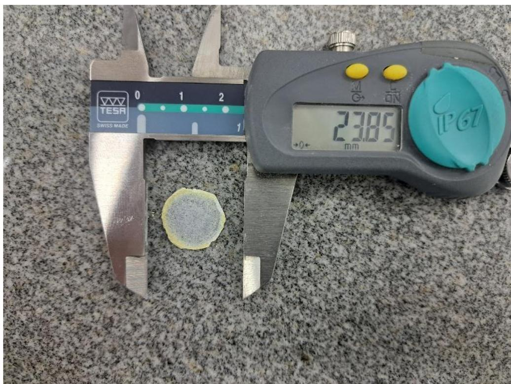
Рисунок 77 – Образец  $\text{BaTiO}_3$ , изготовленный при 300 °С
