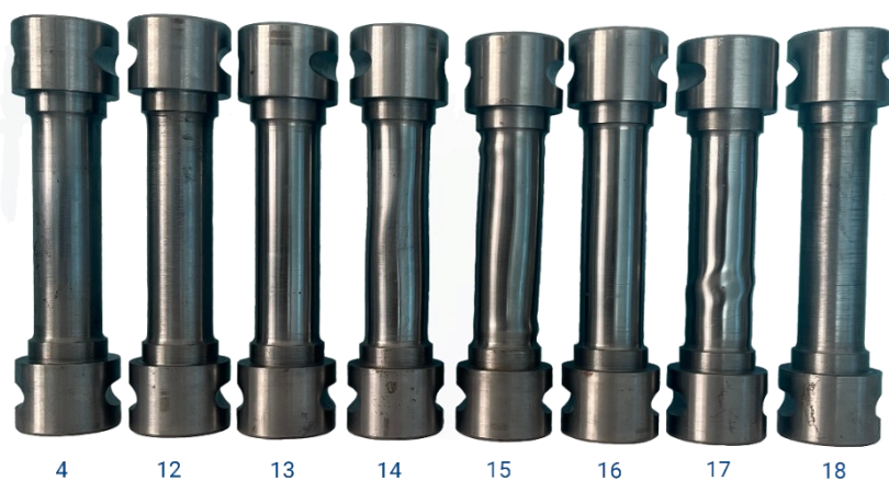
Рисунок 1 – Образцы после испытаний, вер 2%
