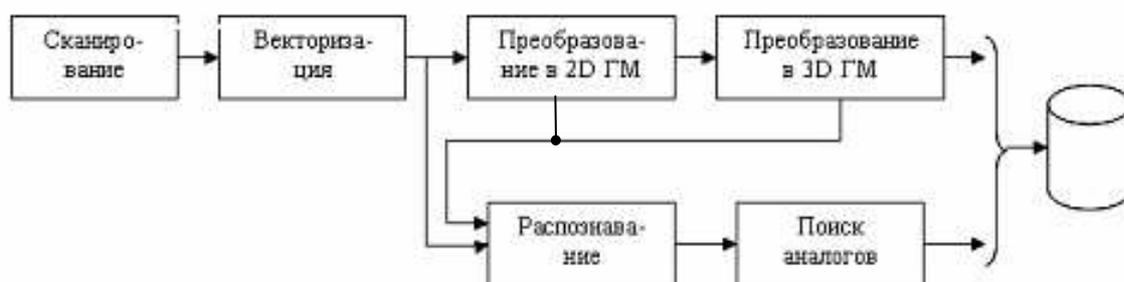
Рисунок 1.11 - Схема обработки чертежной информации при создании электронного архива.
