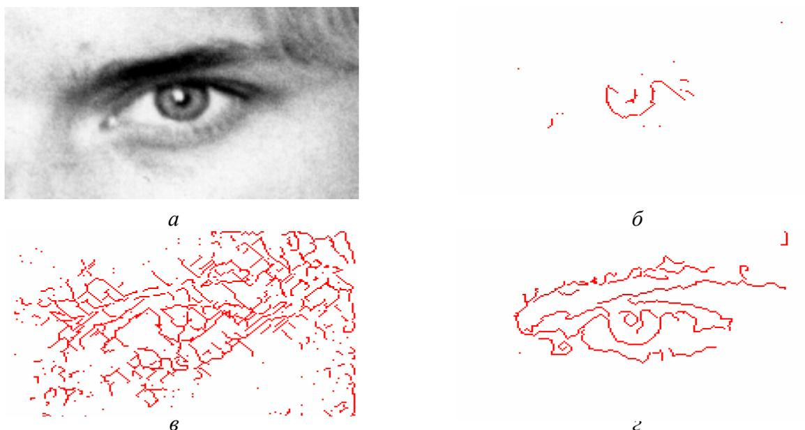
Рисунок 3.10 - Отслеживание контурных линий: а) исходное изображение; б) высокий порог на перепад яркости; в) низкий порог; г) адаптивный порог
