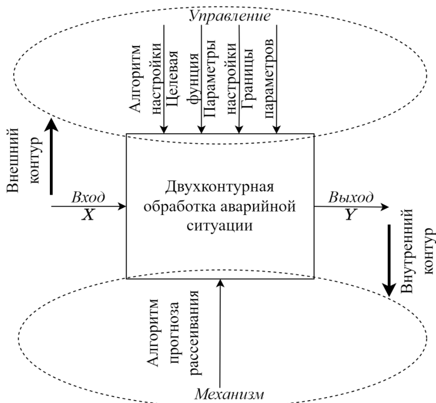
Рисунок 1.5 - Двухконтурная обработка информации в системе прогнозирования и визуализации согласно методологии IDEF0
