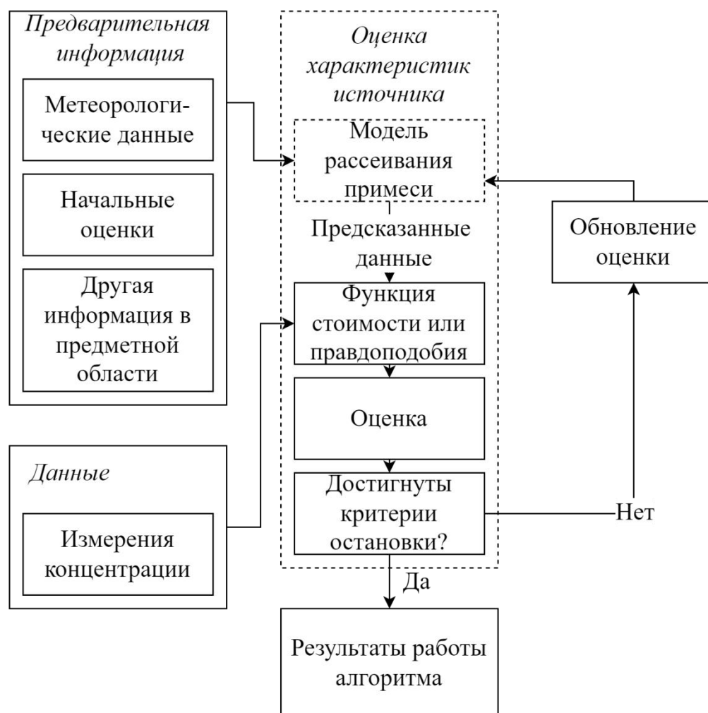
Рисунок 2.1 - Схема обработки информации в подходе STE [38]
