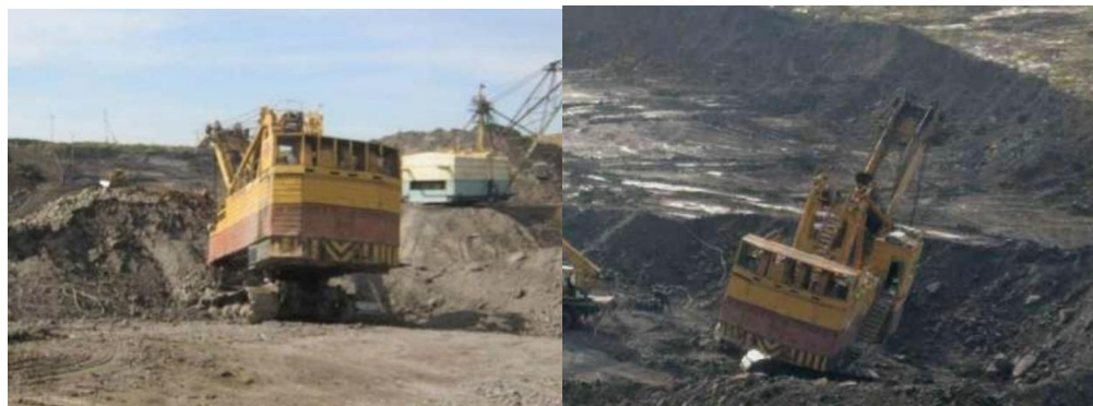
Рисунок 2.9. — Эксплуатация карьерного экскаватора на рабочей площадке с различными углами наклона.
