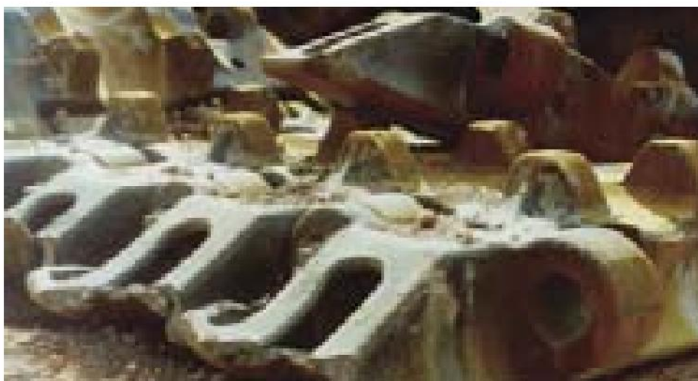
Рисунок 1.12. – Разрушенные боковые части гусеничных траков из-за ударов по ним ковшом.
