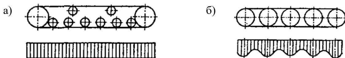
Рисунок 2.3. – Распределение давления на грунт при: а) жесткой многоопорной гусенице и б) жесткой малоопорной гусенице.
