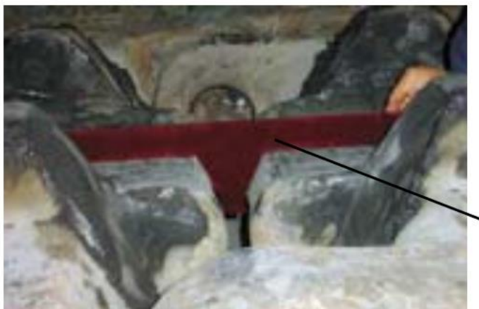
Рисунок 1.11. – Проверка рабочего состояния беговых дорожек гусеничных траков карьерных экскаваторов.
