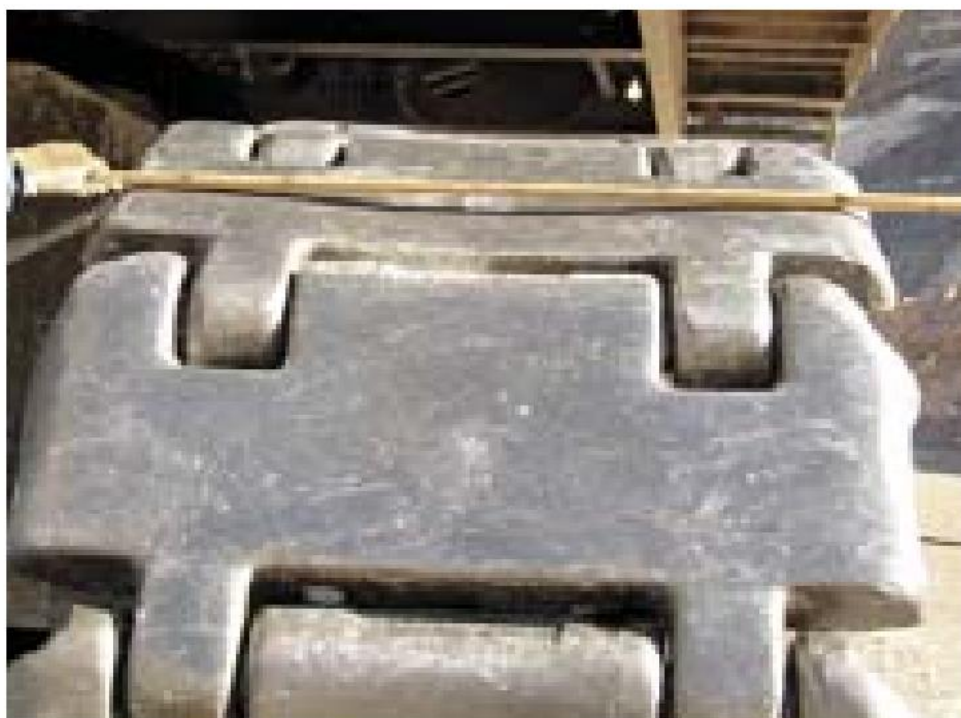
Рисунок 1.10. – Деформация основания конструкции гусеничного трака карьерного экскаватора.
