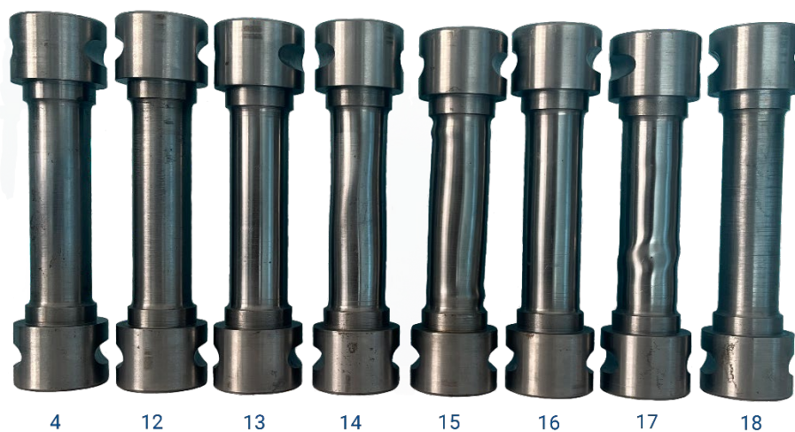
Рисунок 3.10 – Образцы после испытаний, веер 2 %
