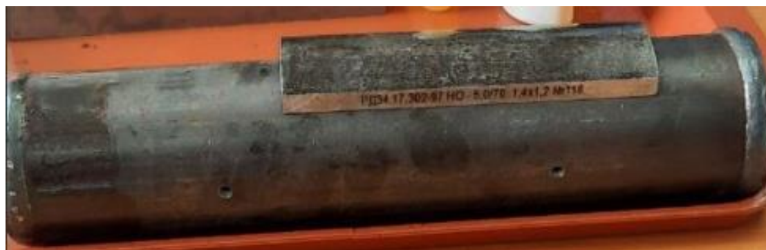
Рис. 2. Стандартный образец предприятия с размером зарубки 1,4×1,2
