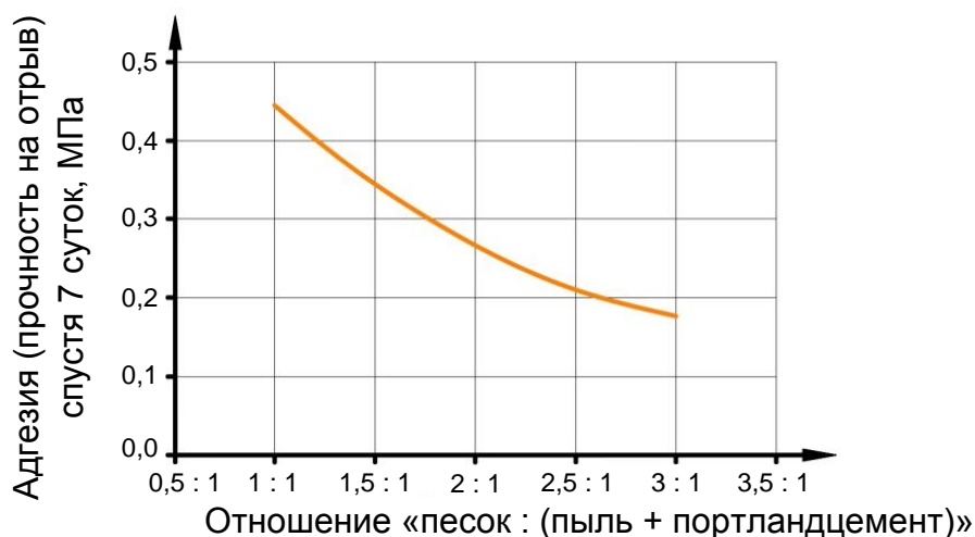
Рис. 3. Графики зависимости адгезии (а) и прочности при сжатии (б) от количества песка в составе смеси
