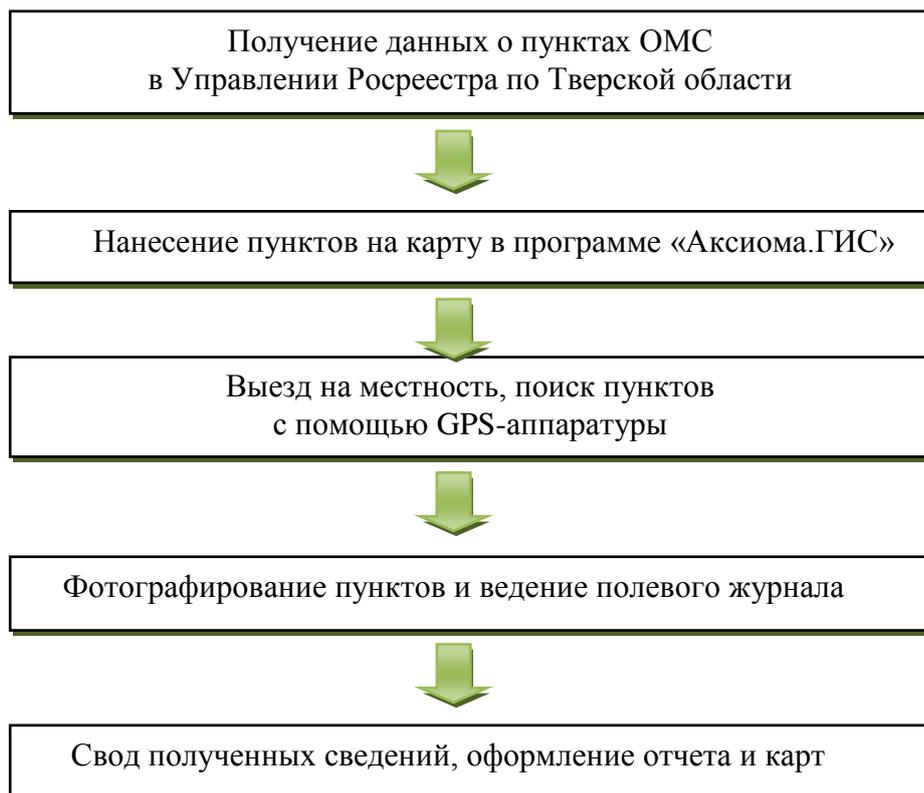
Рис. 2. Порядок осуществления мониторинга геодезических пунктов
