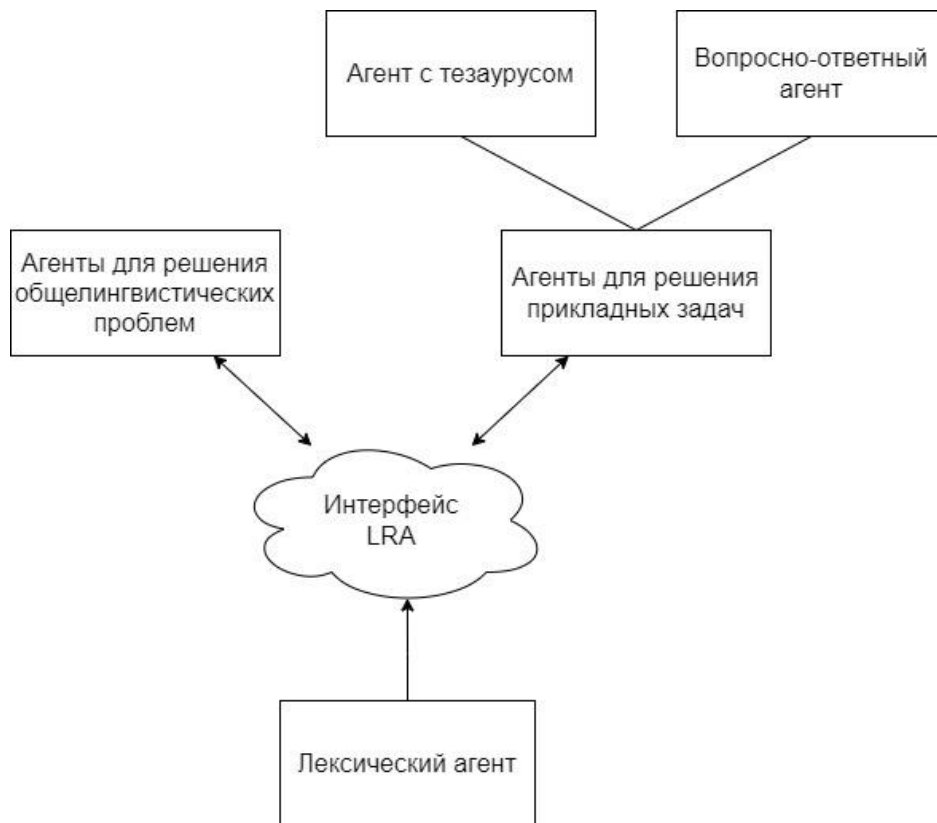
Упрощенная схема системы LRA для построения вопросно-ответной системы
