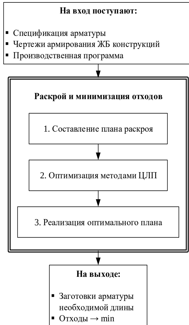
Рисунок 1.2 – Схема процесса подготовки арматуры.
