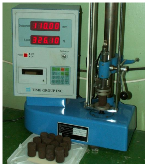
Рисунок 2 – Экспериментальная установка для испытания цилиндрических кусков на сжатие
