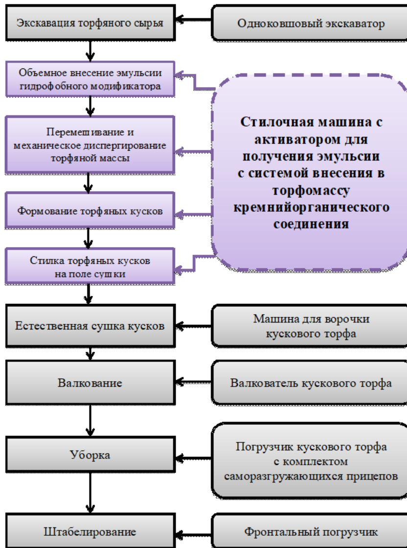
Рисунок 10 – Структурная схема технологии производства кускового торфа в полевых условиях
