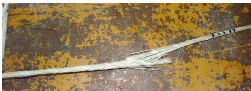
Рис. 2. Характер разрушения композитной арматуры при испытаниях: а – разрыв с расслоением на отдельные волокна; б – разрыв в регионе, локализованном по длине стержня
