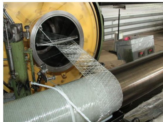
Рис. 1.12. Методы намотки композитных конструкций
