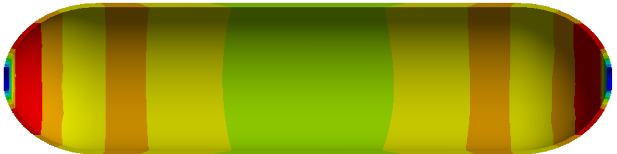
Рис. 3.4. Поле перемещений для B -структуры армирования
