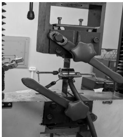
Рис. 1.5. Растяжение, отслеживаемое датчиками гелиевого детектора [31]
