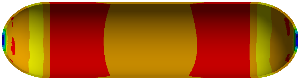
Рис. 3.2. Поле перемещений для реальной A -структуры армирования
