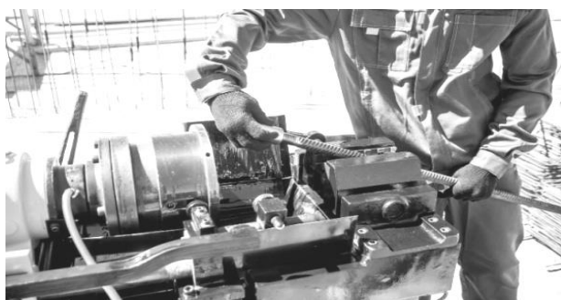
Рис. 2. Накатка резьбы на станке
