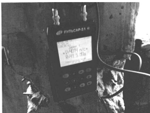
Рис. 4. Сквозное прозвучивание прибором «Пульсар-2.1»
