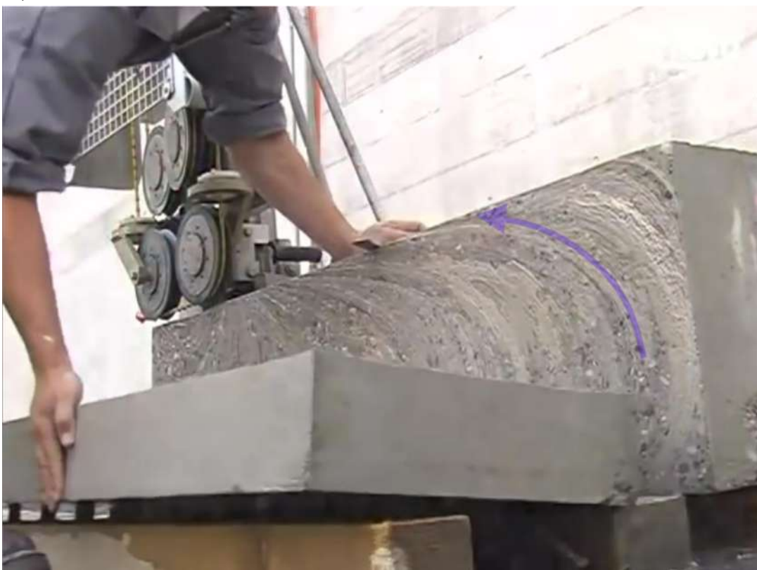
Рисунок 6.14 – Поверхности плит, полученные после алмазно-канатного распиливания с малой (г) и большой кривизной (д) запилов
