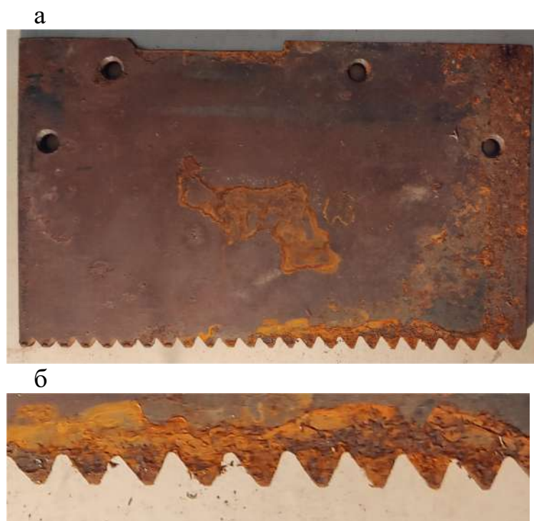
Рисунок 5.14 – Ударная пила прямоугольного профиля корпуса с зубьями трапецеидального профиля с углом наклона их боковой поверхности \delta = 20 - 35^\circ , позволяющей производить распиливание под углом отклонения оси ударника отбойного молотка от вертикальной оси \psi , равного 0 - 45^\circ : а – общий вид, б – зубья пилы
