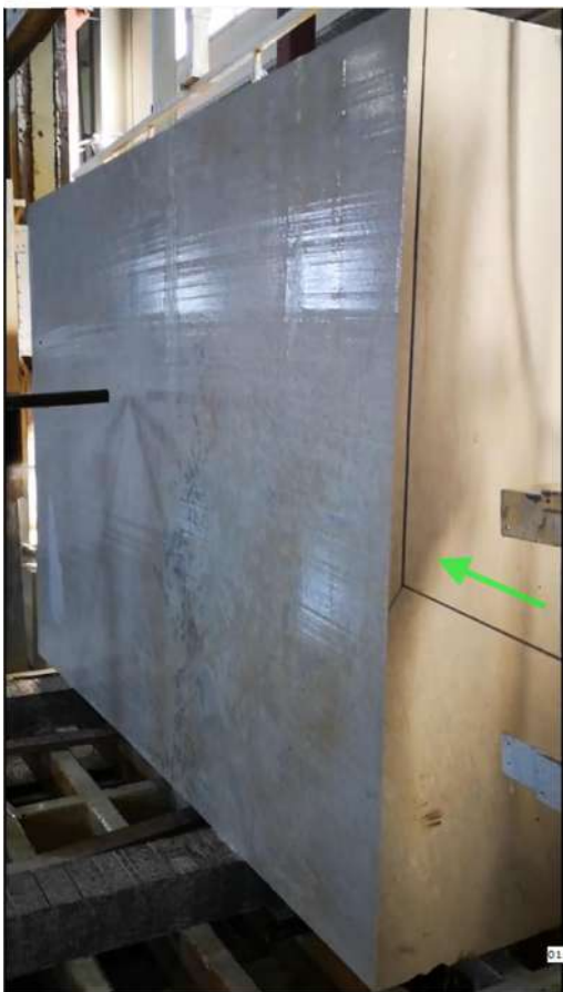
Рисунок 6.14 – Поверхности плит, полученные после алмазно-канатного распиливания с большой (а) и малой (б, в) кривизной запилов
