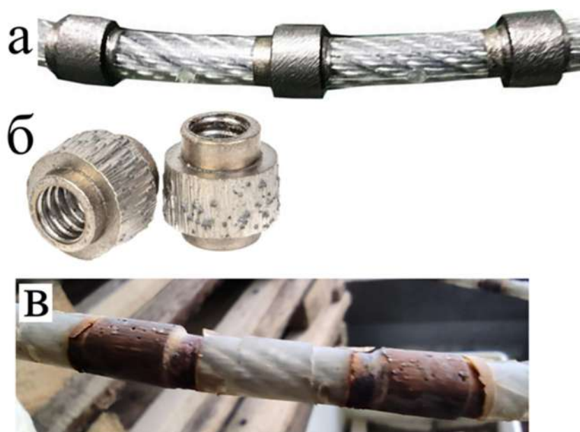
Рисунок 1.10 – Алмазно-канатная пила и алмазные сегменты: новые (а), (б), изношенные (в)
