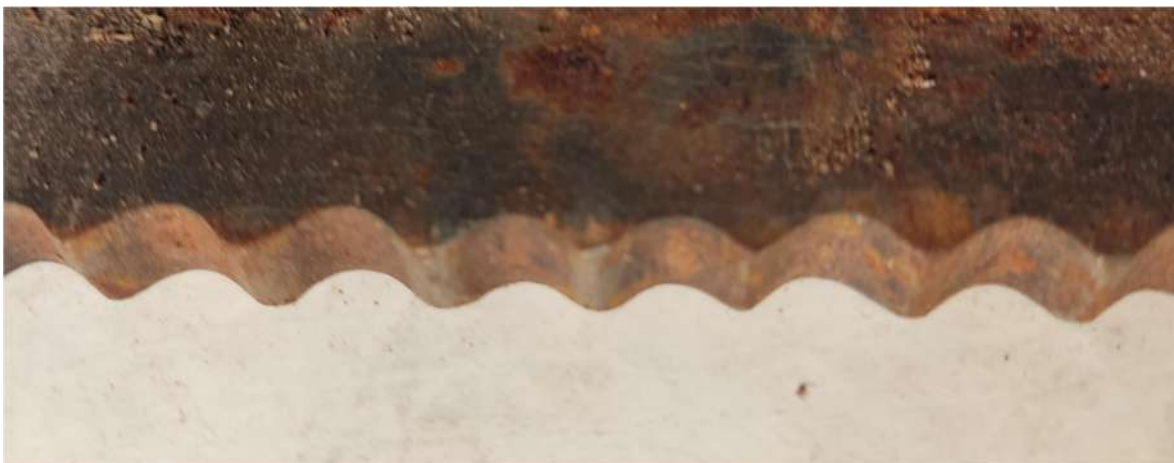
Рисунок 5.11 – Ударная пила квадратного профиля корпуса с зубьями трапецеидального профиля с углом наклона их боковой поверхности \delta = 40 - 45^\circ : а – общий вид, б – зубья пилы
