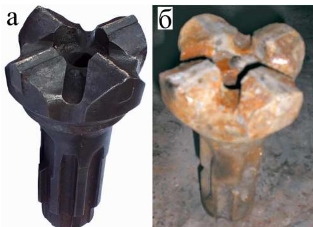
Рисунок 1.3 – Крестовая коронка для погружного пневмоударника: новая (а), изношенная (б)
