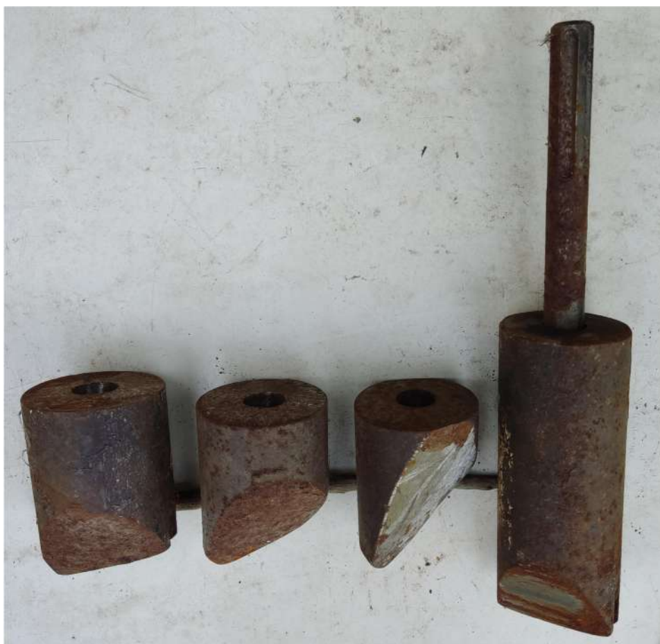
Рисунок 5.16 – Переходники, предназначенные для передачи ударных волн от волновода к ударной пиле, позволяющие производить распиливание под углом отклонения оси ударника отбойного молотка от нормальной плоскости \psi , равным: 0^\circ , 15^\circ , 30^\circ , 45^\circ (в разных ракурсах)
