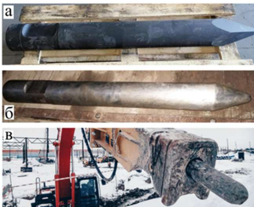
Рисунок 1.7 – Пика гидроударника: новая (а), приработанная (б), изношенная (в)
