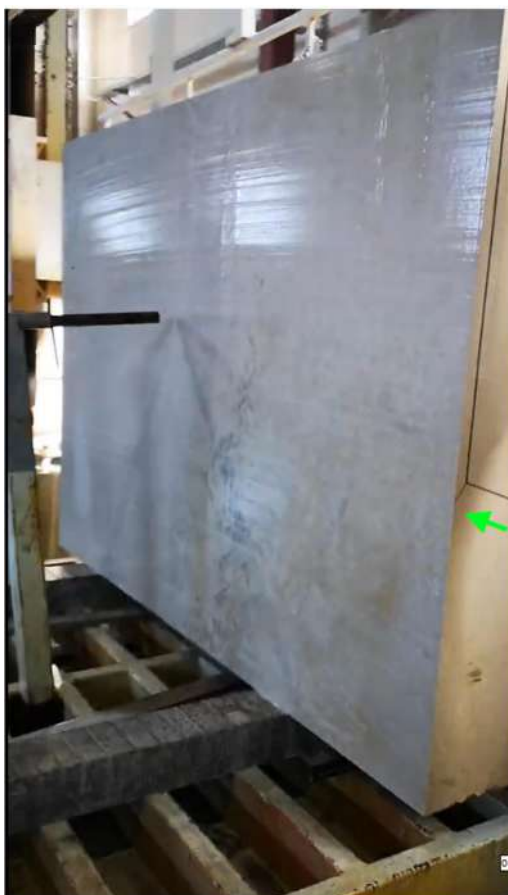
Рисунок 6.14 – Поверхности плит, полученные после алмазно-канатного распиливания с большой (а) и малой (б, в) кривизной запилов
