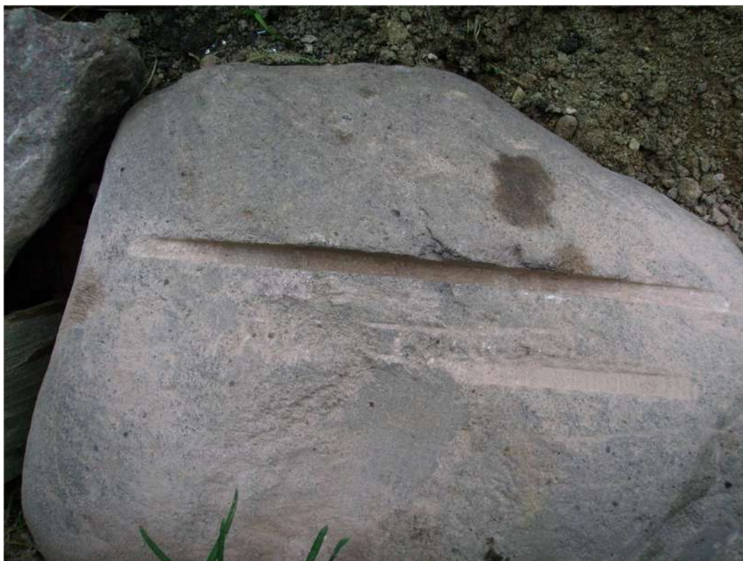
Рисунок 5.10 – Пропил, полученный с помощью станка СУР
