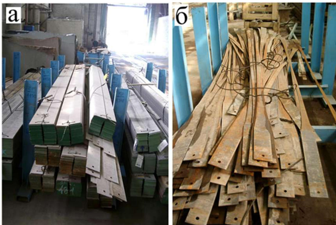
Рисунок 1.12 – Штрипсовые пилы: новые (а), изношенные (б)
