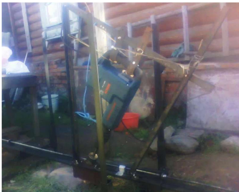
Рисунок 5.9 – Экспериментальная модель станка «СУР Мастерская» с угловым расположением ударного механизма относительно распиливаемого блока
