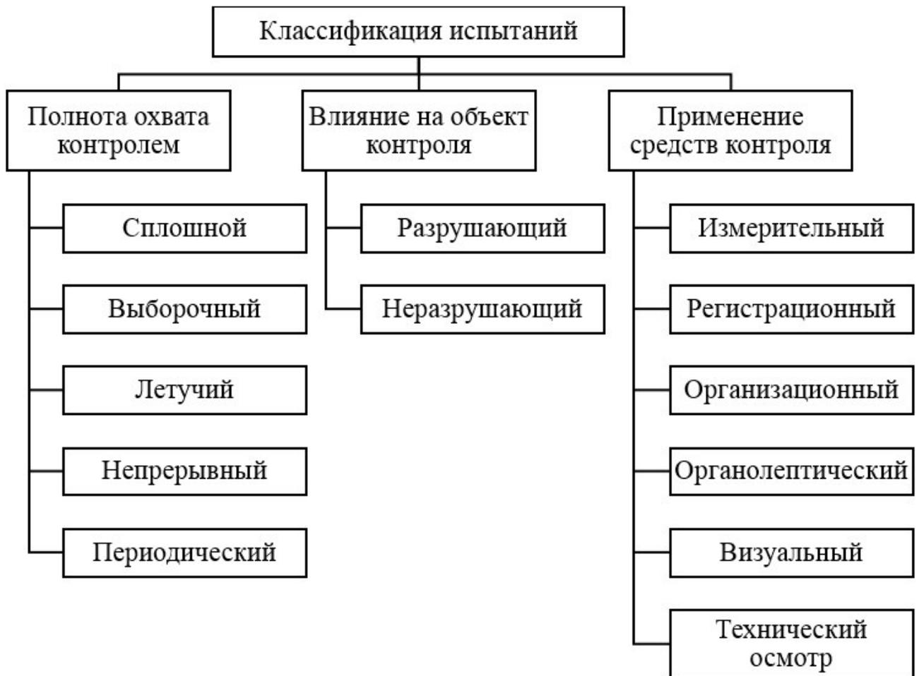
Рис. 1.1.4 – Классификация испытаний (продолжение)
