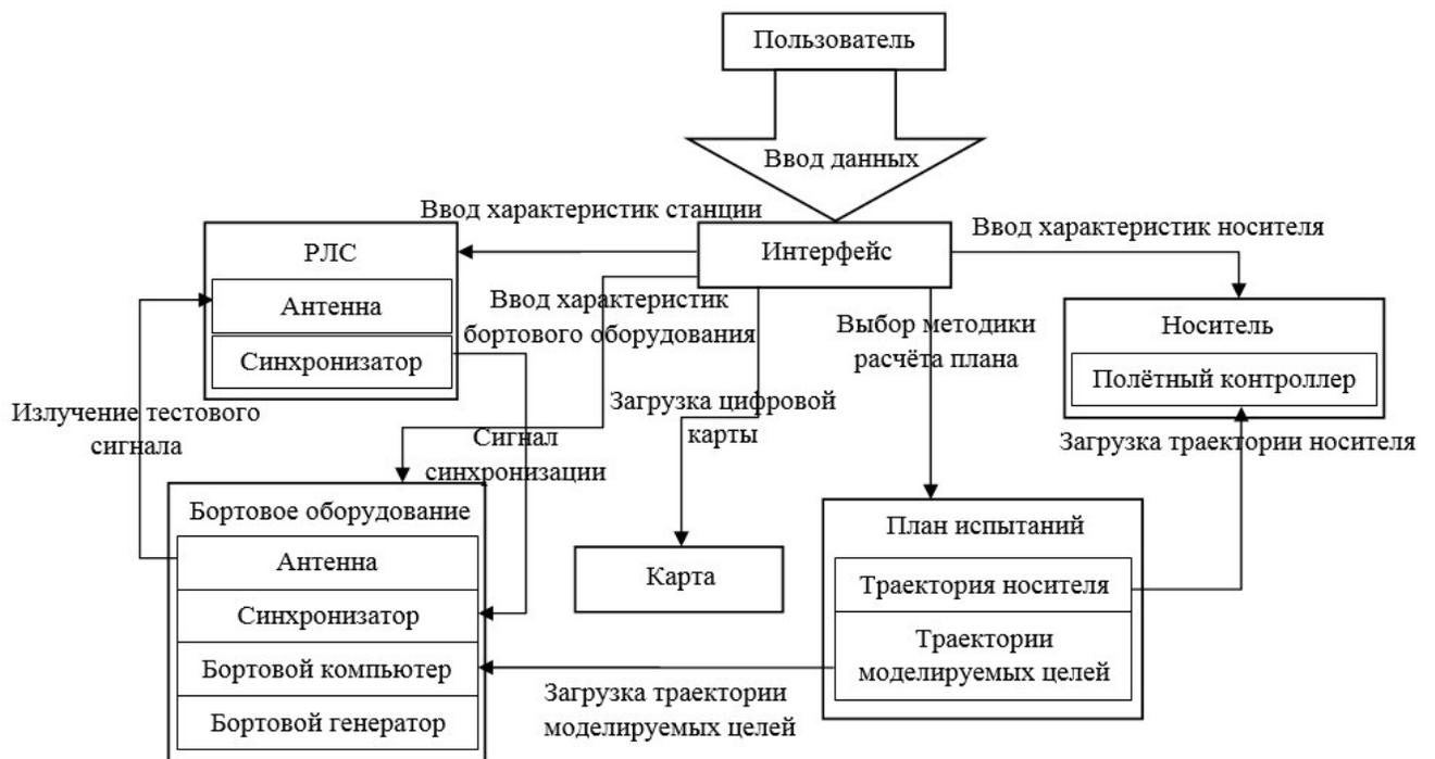
Рис. 4.1 – Схема взаимодействия компьютерных моделей внутри приложения для планирования и моделирования хода проведения испытаний
