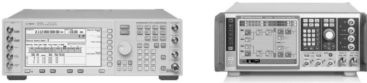
Рис. 1.3.2 – Примеры векторных генераторов сигналов
