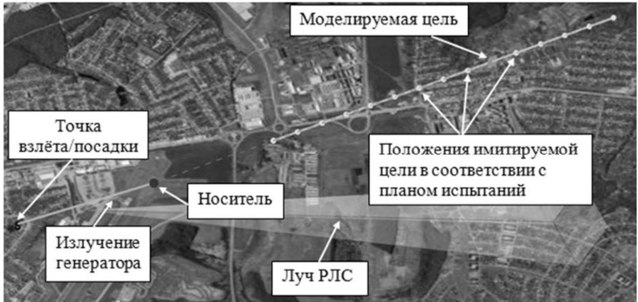
Рис. 3.1.1.1 – Схема проведения испытаний на определение дальности обнаружения с использованием одной моделируемой цели
