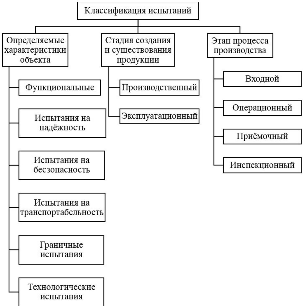
Рис. 1.1.3 – Классификация испытаний (продолжение)
