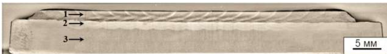
Рисунок 2.2. – Макроструктура наплавленного образца
