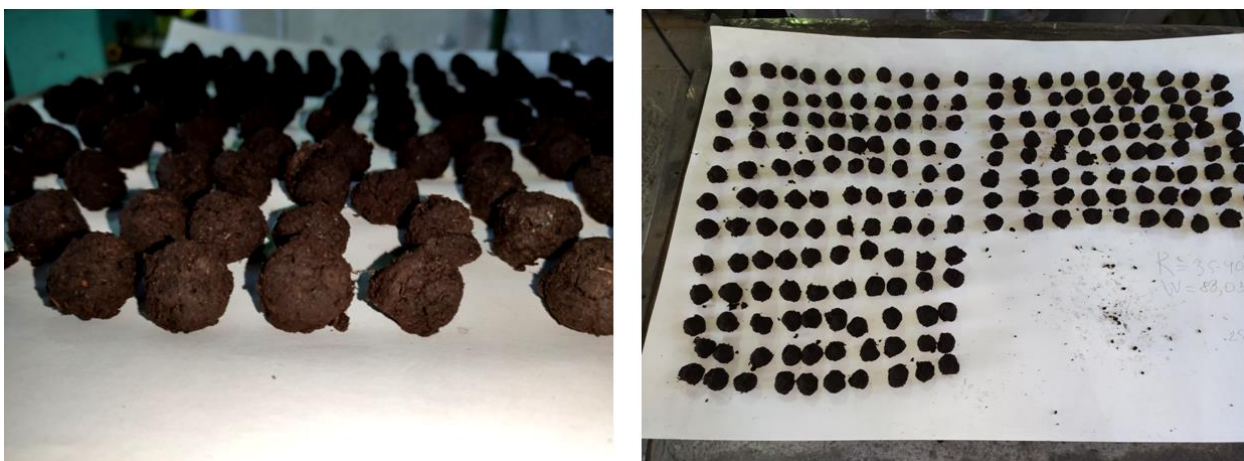
Рисунок 4.2 – Опытные образцы фрезерного торфа сферической формы диаметром 25 мм
