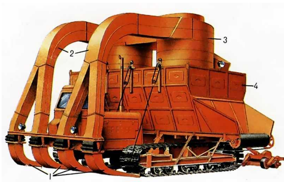
Рисунок 1.5 – Пневматический комбайн БПФ-3М: 1 – всасывающие сопла; 2 – транспортные трубопроводы; 3 – циклон; 4 – бункер
