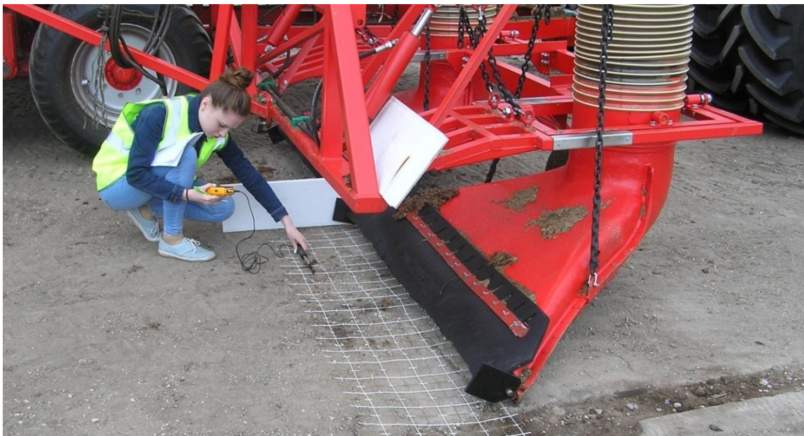
Рисунок 3.4 – Снятие показаний скорости воздушного потока перед соплом
