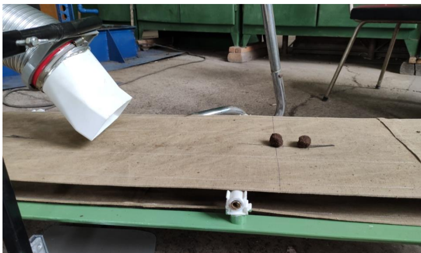
Рисунок 4.10 – Экспериментальное исследование по всасыванию опытных образцов фрезерной торфяной крошки
