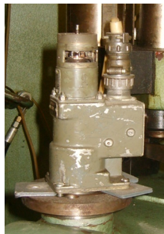
Рис. 3.5. Червячный редуктор комплекса СН-ЭВМ
