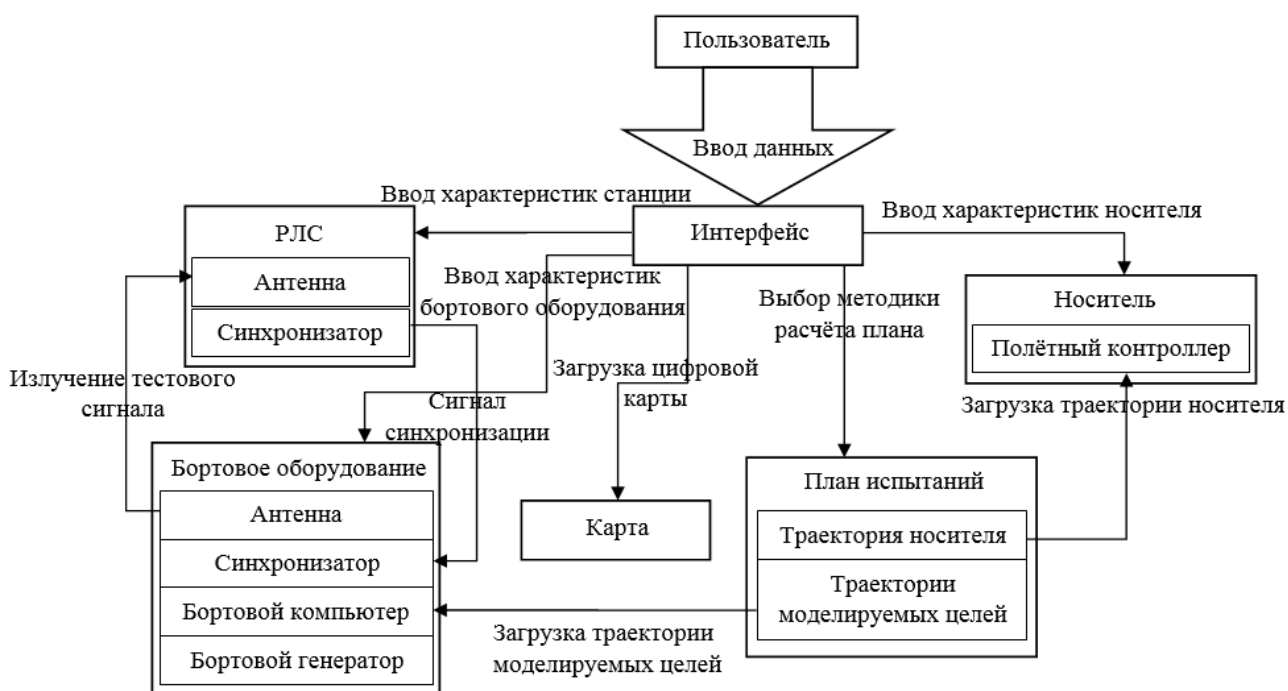
Рис. 6 – Схема взаимодействия компьютерных моделей внутри приложения для планирования и моделирования хода проведения испытаний
