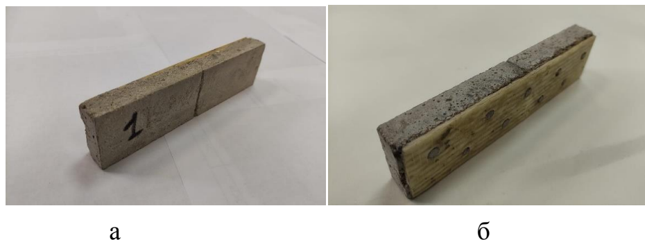
Рис. 2. Образец двухслойной сборной балочки после испытания: а – вид бетонного слоя с образованной поперечной трещиной; б – вид полимеркомпозитной пластины без образования трещины
