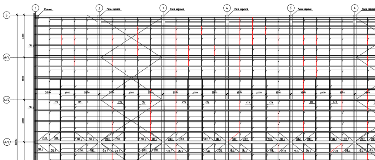
Рис. 4. Схема элементов покрытия в осях 1–6 и А/3–Б
