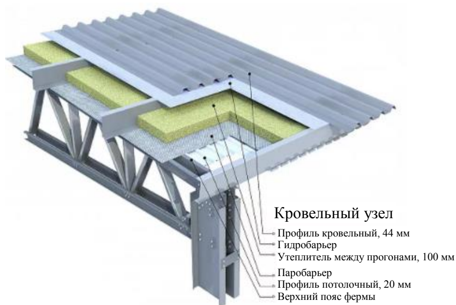
Рис. 3. Кровельный «пирог» индивидуального жилого дома
