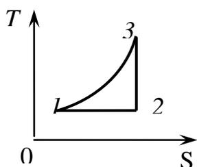
На рисунке изображен цикл  $1-2-3-1$ , совершаемый идеальным газом, в координатах «температура  $T$  – энтропия  $S$ ». Какой из процессов этого цикла осуществляется без теплообмена с окружающей средой и почему? Расширяется или сжимается газ в этом процессе?
