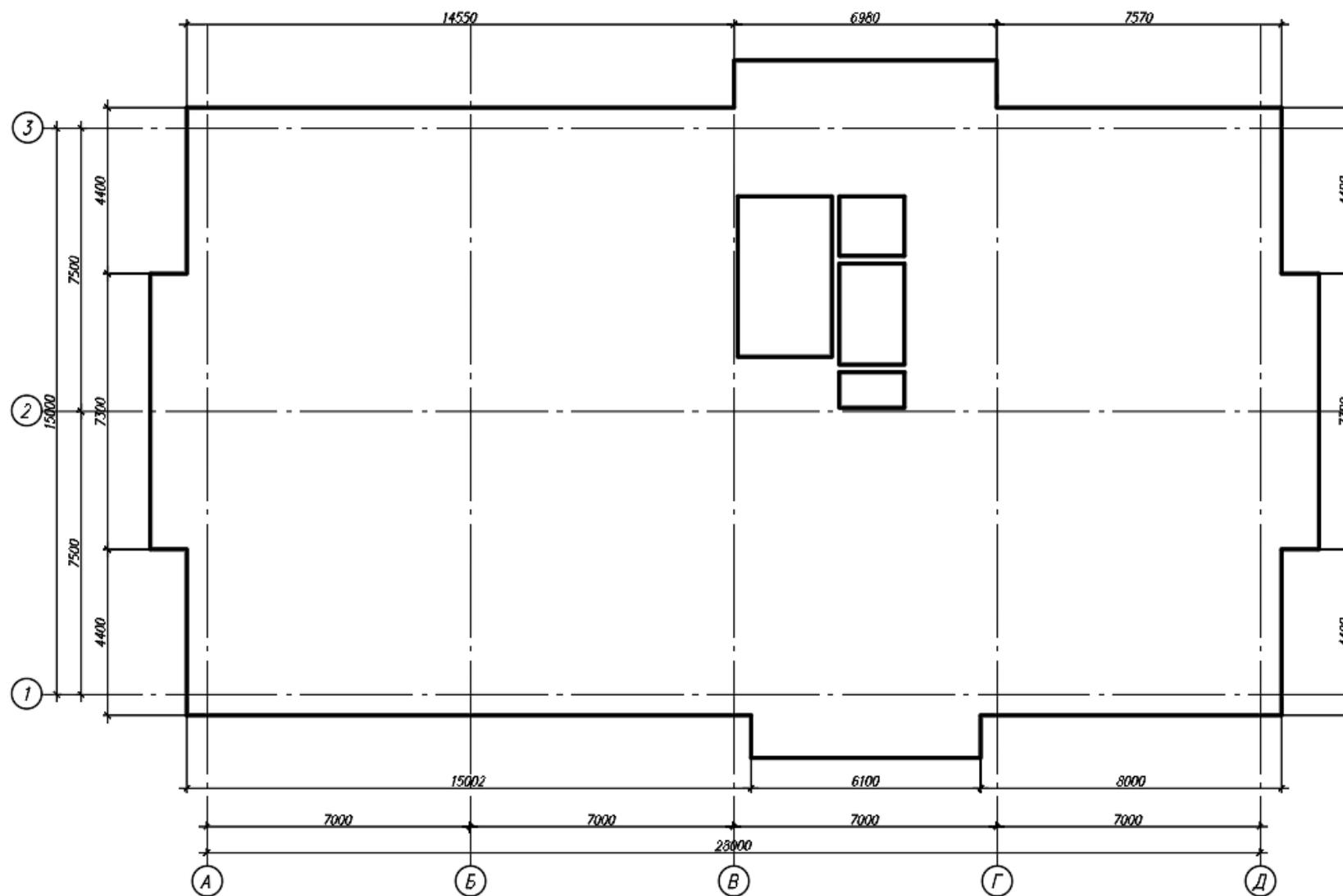
Рис. 2. План плиты перекрытия с габаритами в крайних осях
