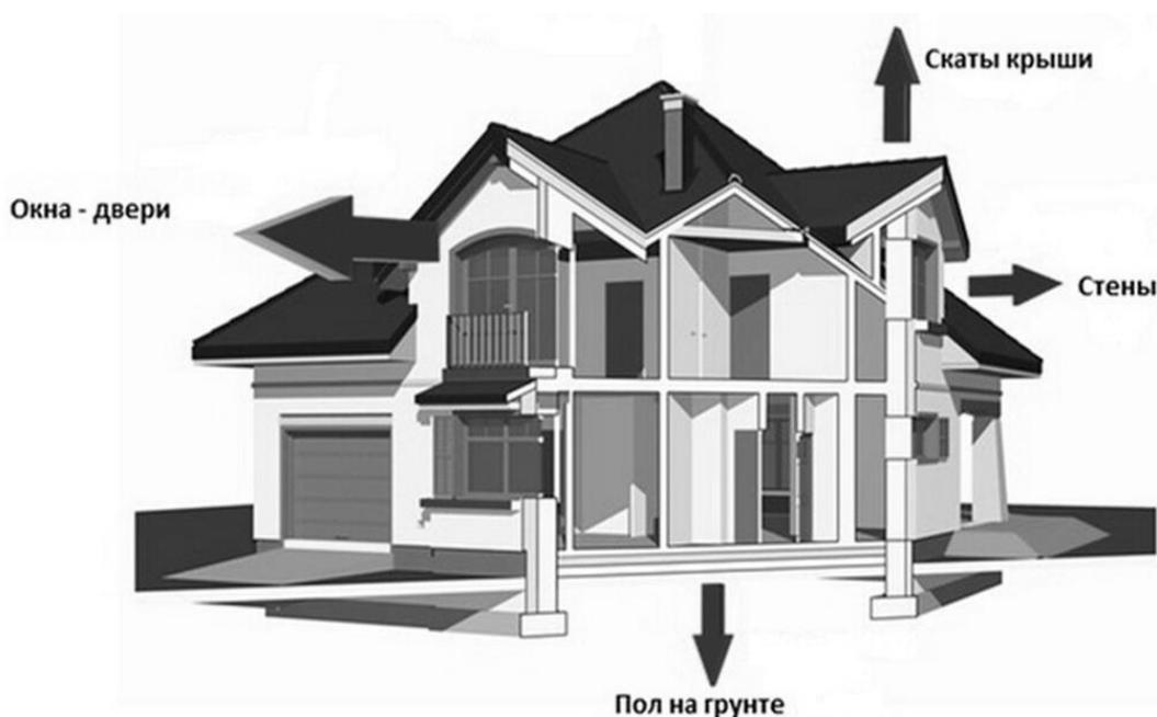
Рис. 2. Теплопотери ограждающих конструкций
