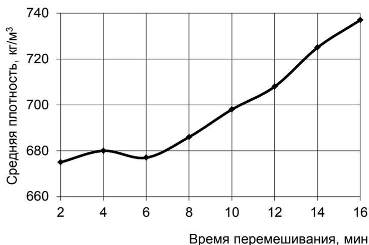
Рис. 3. Зависимость средней плотности газобетона от времени перемешивания
