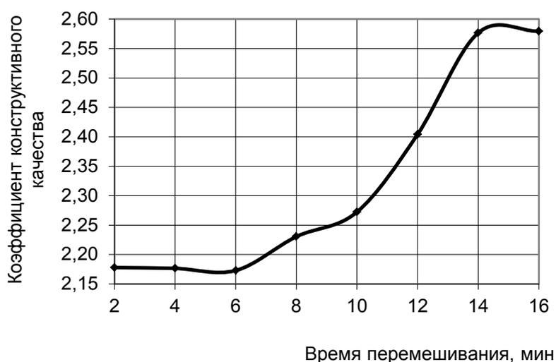
Рис. 4. Зависимость коэффициента конструктивного качества газобетона от времени перемешивания
