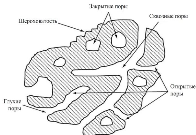
Рис.1.2. Схематическое изображение пористой структуры [37,38].
